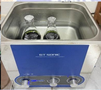
Gambar 5. Maserasi berbantuan ultrasonik
