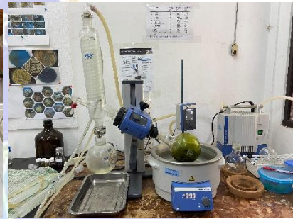
Gambar 6. Penguapan pelarut dengan rotary evaporator
