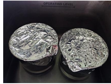
Fabrikasi \text{Fe}_3\text{O}_4 -NPs dengan CDs dengan sonikasi
