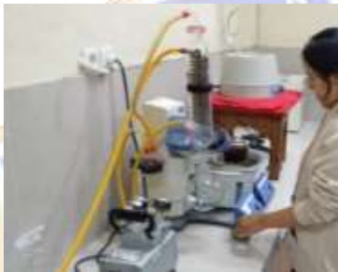
Gambar 4. Proses Esktraksi Larutan Daun Pepaya
