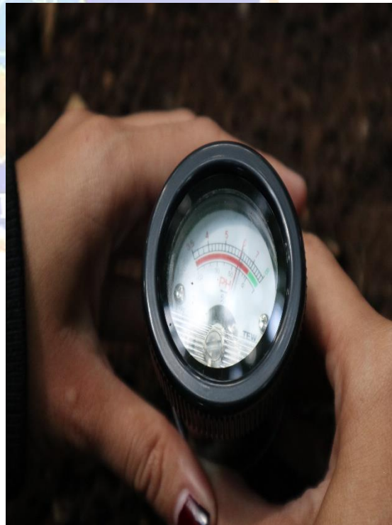
Gambar : Pengukuran pH tanah
