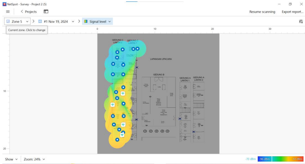
Pengukuran Sinyal Blank Spot Pada Gedung C Menggunakan NetSpot
