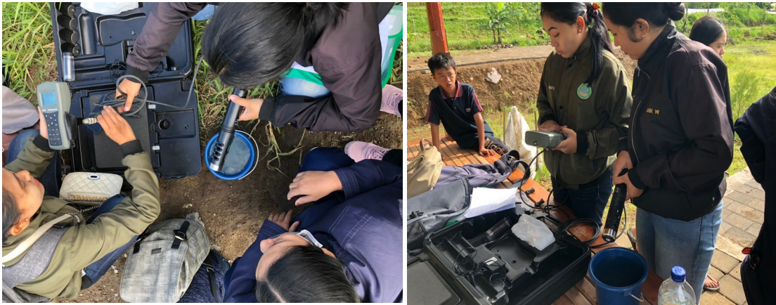
Gambar. Pengukuran Air Danau Buyan dengan Water Quality Checker
