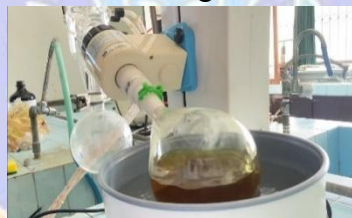
Proses evaporasi dengan menggunakan evaporator
