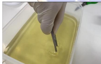
Setelah homogen, larutan dituangkan ke wadah preparasi cellophane dan meletakkan cellophane
