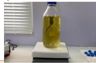
Menyatukan akuades, gliserin, ekstrak menggunakan stirer hingga homogen
