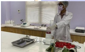
Proses blender dari limbah bunga canang yang sudah dipotong kecil-kecil
