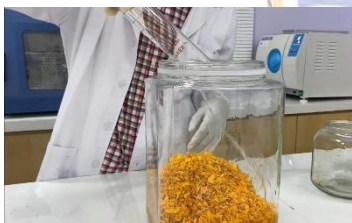
Proses memasukkan etanol 96% pada limbah bunga canang
