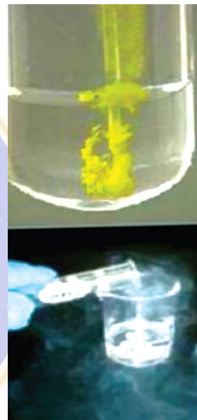
Gambar 17. Pembentukan endapan timbal iodida Sumber: Dok. Kemdikbud
