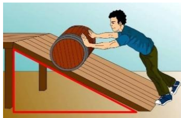
Gambar 1. Seorang pria mendorong drum ke atas truk dengan bidang miring
