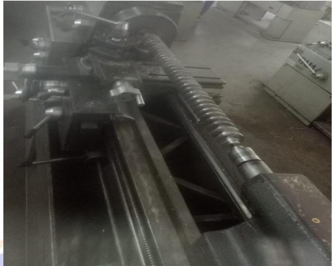
Pada proses pembuatan *screw* ada beberapa pengerjaan yaitu dimulai dari pengelasan dan pembubutan agar nantinya ukurannya tepat untuk dimasukkan ke tabung *screw*
