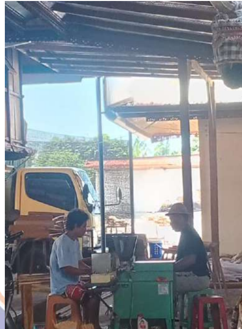
Gambar 13. Proses Perekatan Produk Dupa Pada Stik
