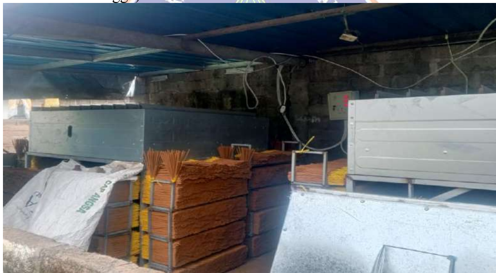
Gambar 18. Alat Pengering Produk Dupa Setelah Diolah
