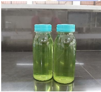
Filtrat ZnO-NPs hasil sentrifugasi
