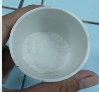
Endapan ZnO-NPs setelah di furnace pada suhu 500^\circ\text{C}
