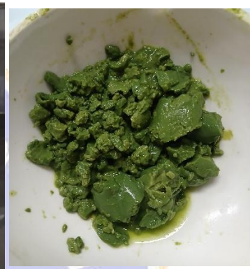
Campuran \text{CH}_3(\text{COO})_2 dan \text{ZnCl}_2 1M setelah ditambahkan ekstrak daun kelor
