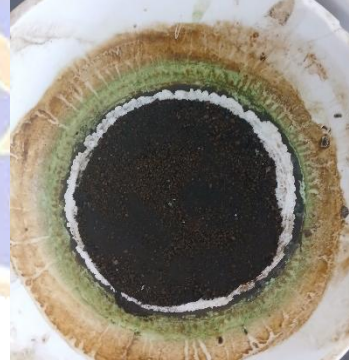
CuO-NPs setelah di oven pada suhu 80^\circ\text{C}
