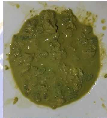
Endapan ZnO-NPs hasil sentrifugasi
