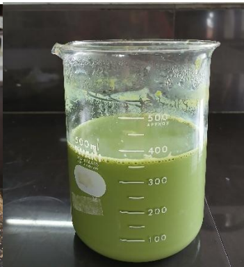
Larutan CuO/ZnO-NPs setelah pemanasan selama 1 jam 30 menit
