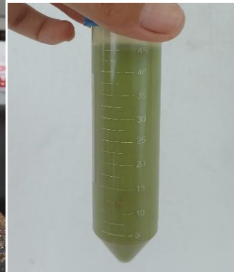
Larutan ZnO-NPs sebelum disentrifugasi
