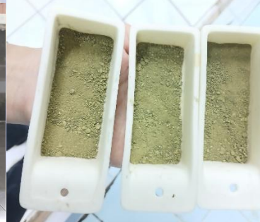
Endapan ZnO-NPs sebelum di furnace pada suhu 500^\circ\text{C}
