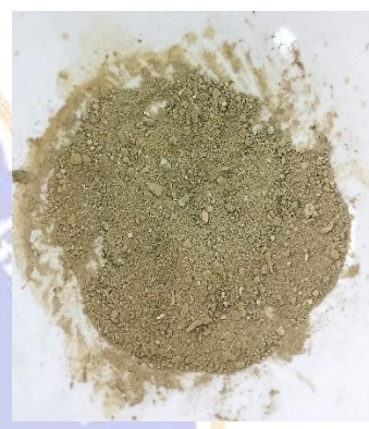
Endapan ZnO-NPs setelah di oven pada suhu 80^\circ\text{C}
