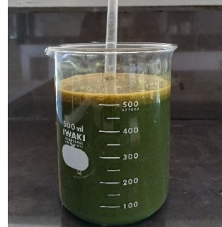
Campuran \text{CH}_3(\text{COO})_2 dan \text{ZnCl}_2 1M setelah ditambahkan ekstrak daun kelor
