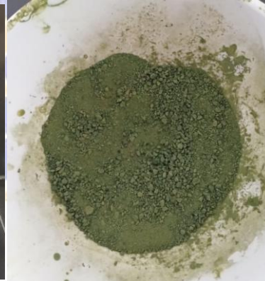
Endapan CuO/ZnO-NPs setelah di oven pada suhu 80^\circ\text{C}
