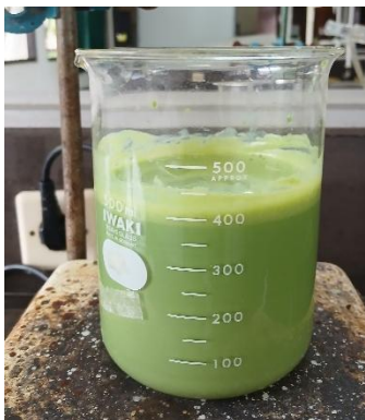
Campuran \text{CH}_3(\text{COO})_2 dan \text{ZnCl}_2 1M setelah ditambahkan ekstrak daun kelor dan NaOH
