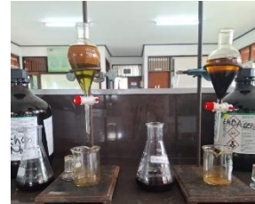
Gambar 3. Fraksinasi Dengan Pelarut Diklorometana dan Etil Asetat
