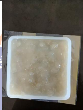
Gambar 5. Proses mencetak bioplastik menggunakan cetakan silikon
