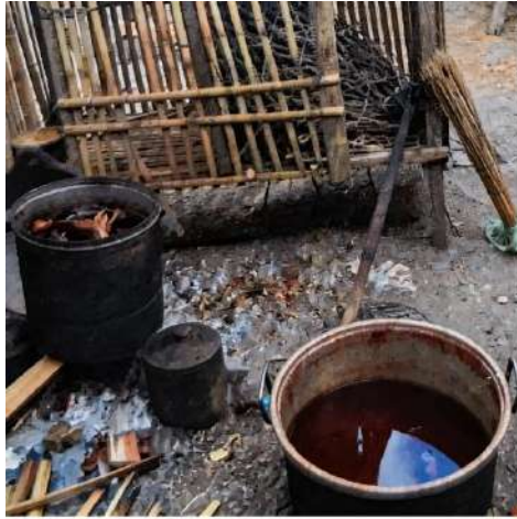
Proses pembuatan pewarna alami dengan metode pemanasan dan fermentasi
