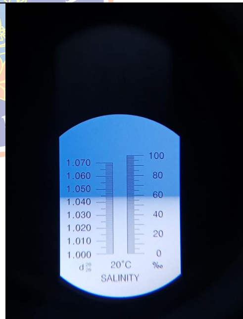
Gambar 8. Hasil pengujian salinitas air dengan menggunakan alat Refraktometer
