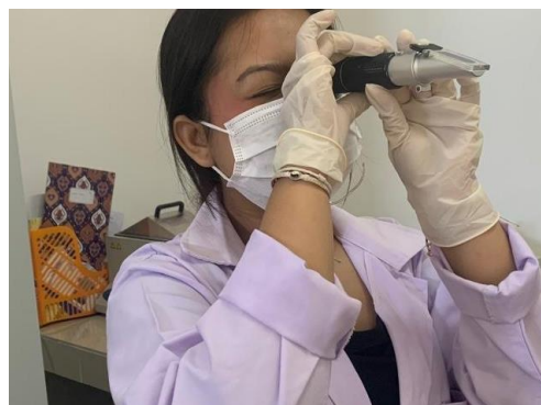
Pengecekan salinitas ASW
