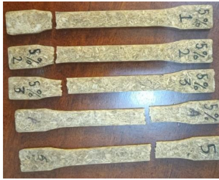
Spesimen Fraksi Volume 5%
