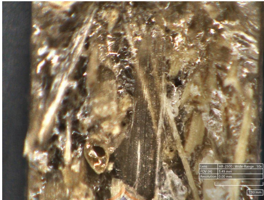
Pola patahan Fraksi Volume 7,5%
