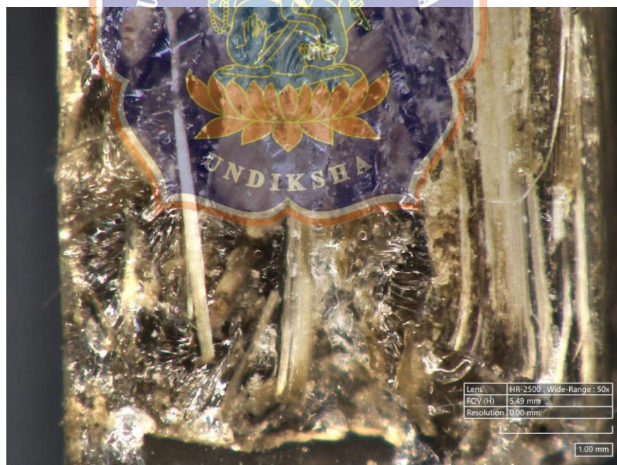
Pola patahan Fraksi Volume 10% Perbesaran 50x
