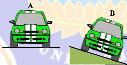
Gambar 1. a) mobil mengitari belokan datar, b) mobil menikung pada bidang miring
