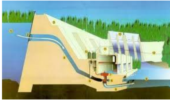
Gambar Penerapan Hukum Hidrostatik dalam Pembuatan Bendungan
