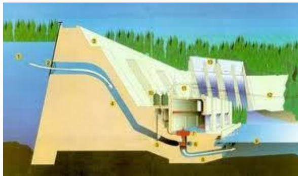
Gambar Penerapan Hukum Hidrostatik dalam Pembuatan Bendungan
