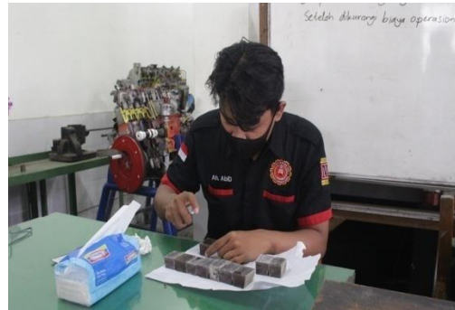
Pembersihan specimen menggunakan alcohol dan tisu sebelum memulai pengujian (sumber : ahmad abidurohman, skripsi;2020)
