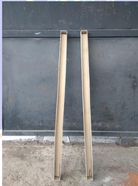
Cetakan komposit bahan karton tebal (sumber : ahmad abidurohman, skripsi;2020)
