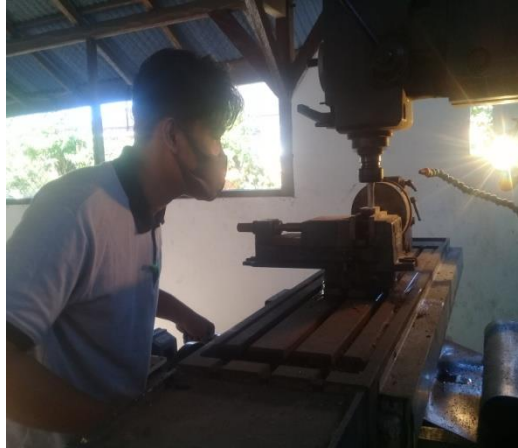
Proses pemesinan frai, pada specimen (sumber : ahmad abidurohman, skripsi;2020)
