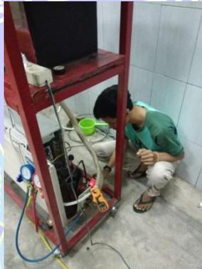
Saat melakukan pengecekan suhu pada pada jalur pipa masuk ke kompresor
