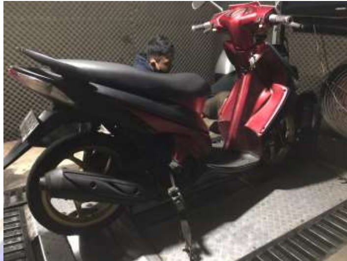
Lampiran 4. Proses pemasangan kendaraan pada alat dynotest
