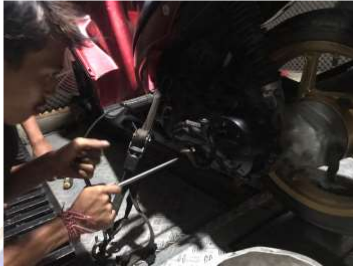
Lampiran 3. Proses bongkar pasang roller pada CVT
