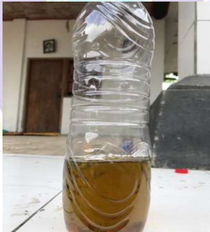
Lampiran 4. 500 ml campuran pertalite dengan minyak dari limbah plastik perbandingan 60:40
