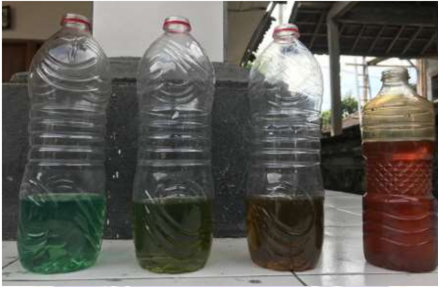
Lampiran 1. Campuran bahan bakar pertalite dengan bahan bakar limbah plastik
