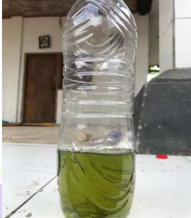
Lampiran 3. 500 ml campuran pertalite dengan minyak dari limbah plastik perbandingan 80:20
