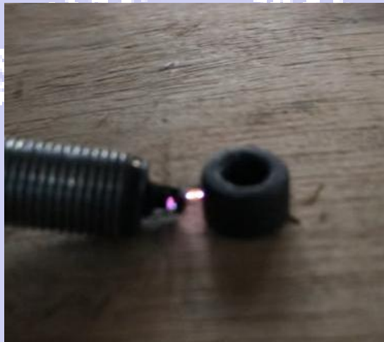
Percikan Bunga Api Busi Koil Groundstrap Perak (Sumber : Dokumen Pribadi)
