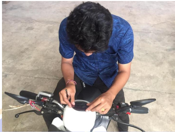
Mengukur Sudut Belok Kendaraan Menggunakan Busur Derajat.
