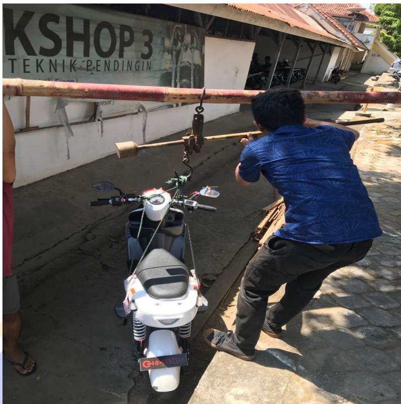
Mengukur Berat Total Kendaraan Menggunakan Timbangan.
