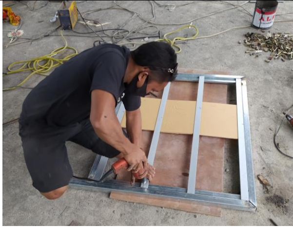
Gambar 1. Proses Pembuatan Rangka Besi Penyangga
