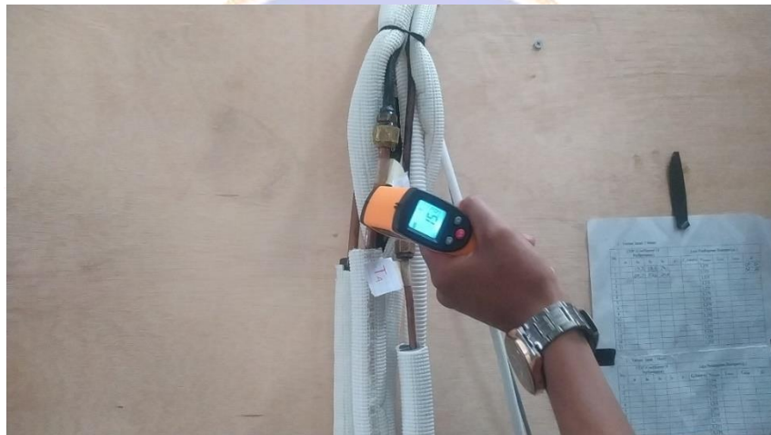
Gambar 9. Pengujian Pada Pipa Hisap Setelah Evaporator ( T_1 )
