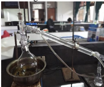
(d) Proses distilasi sederhana
