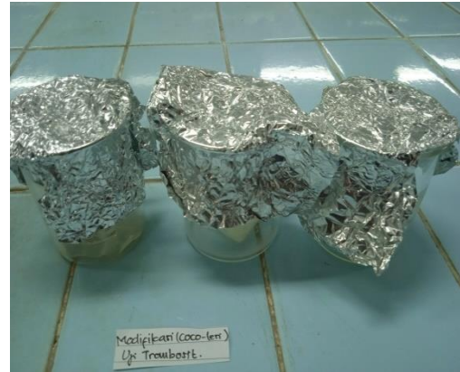
Gambar 5. Proses perendaman dengan PKT pada membran nata de coco dan membran nata de coco-leri
