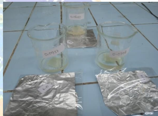
Gambar 3. Proses perendaman dengan larutan PBS pH 7,4
