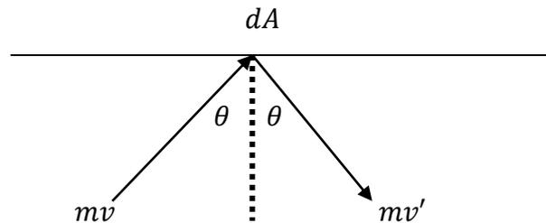
Gambar H.3. Perubahan momentum dari sebuah molekul yang menghantam elemen permukann  $dA$  (gambar dibuat dengan menggunakan Microsoft Office Word).
