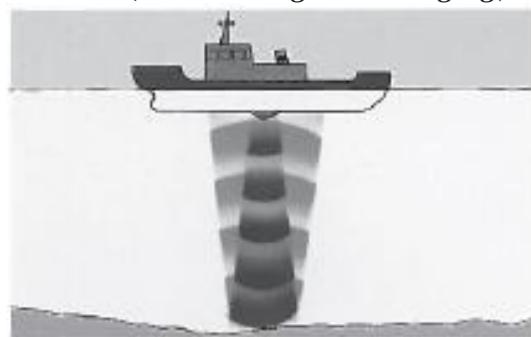
Gambar 4. Sonar yang digunakan untuk mengukur kedalaman laut
