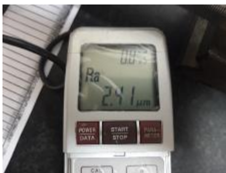
Gambar 4. Contoh Data Material ST 42 Dengan Pahat Potong Karbida Widia
