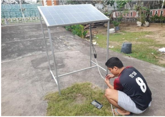
Pengecekan Tegangan dan Arus Pada Panel Surya
