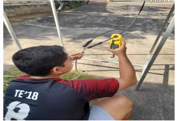
Pengecekan Tegangan dan Arus Pada Panel Surya
