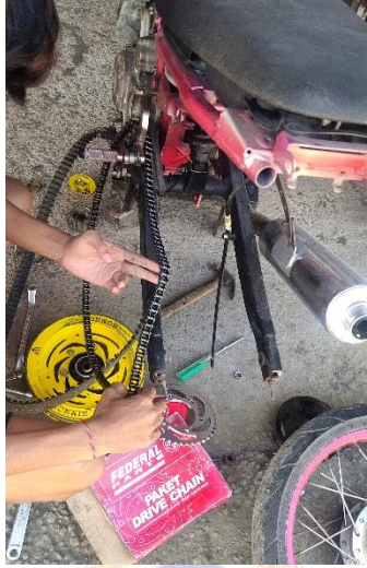
Gambar 4 Penggantian Rantai Menggunakan v belt
