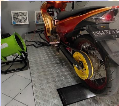
Gambar 2 Pengujian Dynotest Menggunakan V Belt
