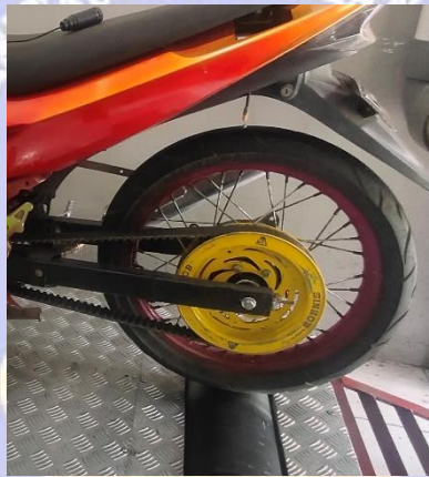
Gambar 5 Memposisikan Roda Belakang Dengan Sejajar Dengan roll dynotest
