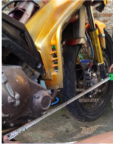
Gambar 6 Mencari Titik Tengah Berat Kendaraan ( wheel base )
