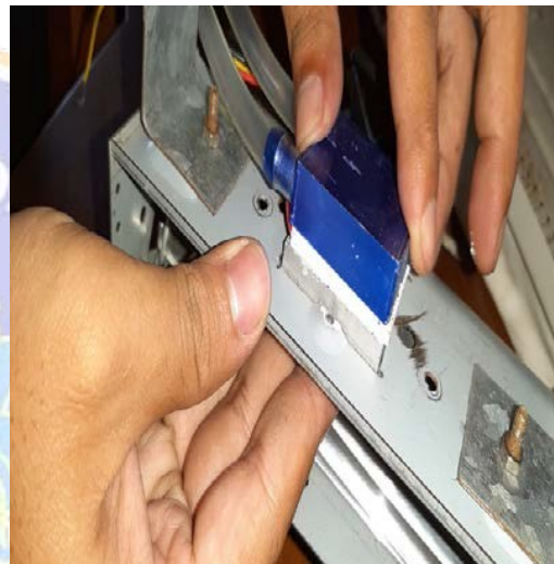
Pemasangan Peltier dan Cooling Heatsink
