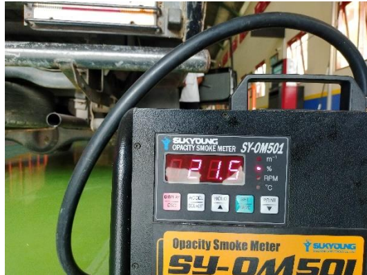
Gambar 10. Hasil Pengujian Opasitas Gas Buang Bio Solar Dengan Penambahan 250ml Zat Aditif
