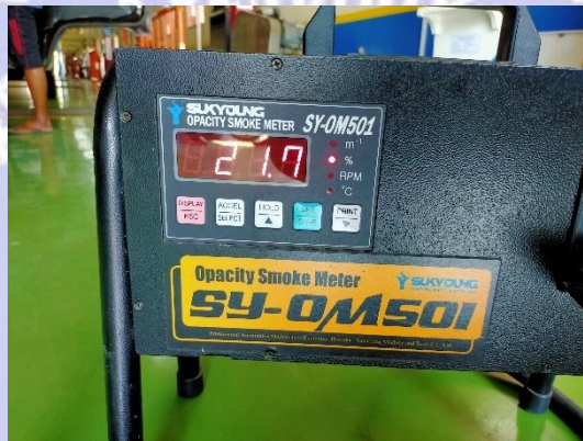
Gambar 8. Hasil Pengujian Opasitas Gas Buang Bio Solar Dengan Penambahan 250ml Zat Aditif
