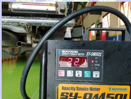
Gambar 6. Hasil Pengujian Opasitas Gas Buang Bio Solar Dengan Penambahan 250ml Zat Aditif
