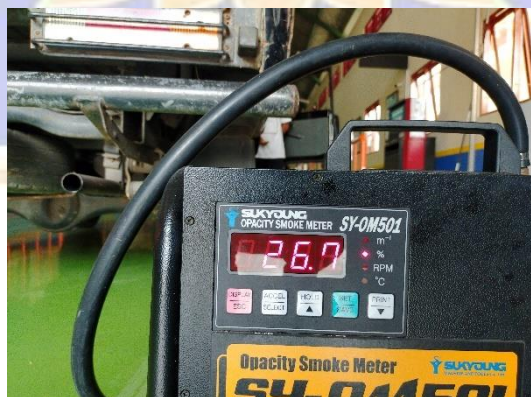
Gambar 1. Hasil Pengujian Opasitas Gas Buang Bio Solar Murni
