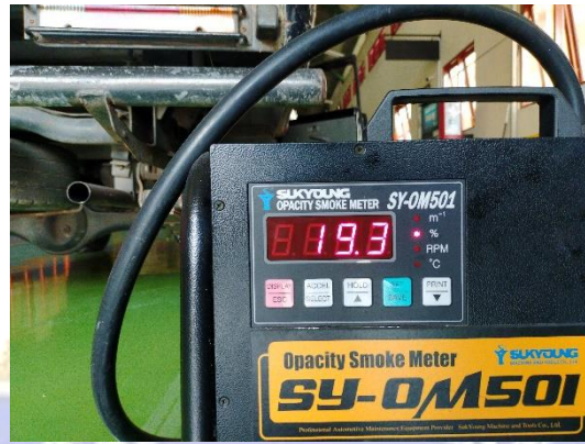
Gambar 15. Hasil Pengujian Opasitas Gas Buang Bio Solar Dengan Penambahan 500ml Zat Aditif
